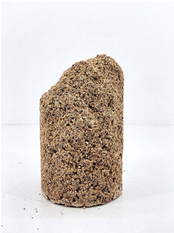
Fig. 9: Sample N.1 after Compressive Test
