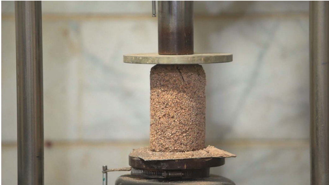
Fig. 22: Sample N.1 during Compressive Test
